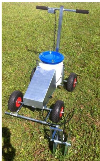
Machine de traçage à pulvérisation électrique pour terrains de sport engazonnés
