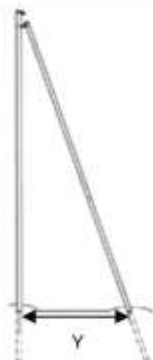
fig. 1 jambe de force de 1.2 à 2.7 m d'entraxe et entretoise selon hauteur
