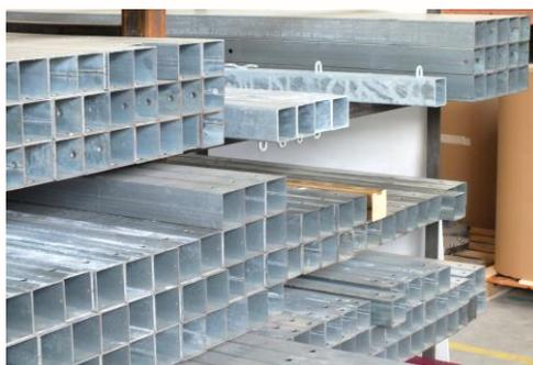
**L'acier** : les ossatures et pièces d'assemblage sont réalisées en acier, galvanisé ou inoxydable. Elles sont façonnées et assemblées par soudure. La galvanisation se fait à chaud après façonnage, par immersion dans un bain de zinc en fusion à 450°C. Leur finition peut être brute ou laquée par poudre polyester.
